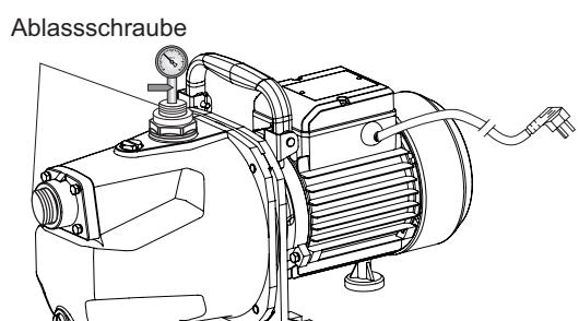
6.4 Luftpichtigkeitsprüfung: Nachdem die Pumpe zur Reparatur oder zum Austausch einer Dichtung demontiert wurde, müssen das Lager und die komplette Pumpe einer Wasserdruk- (oder Luftdruck-)Prüfung von mindestens 3 Minuten Dauer bei maximalem Betriebsdruck unterzogen werden. Dabei darf keine Wasserleckage oder -absonderung auftreten.
