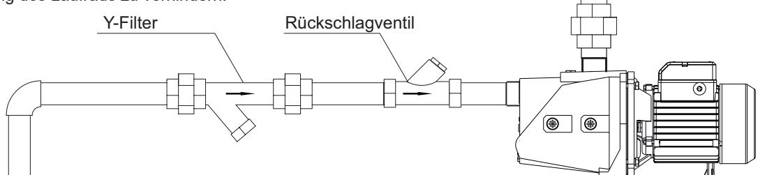
2. Vor der Verwendung der elektrischen Pumpe einen Probelauf von höchstens 10 Sekunden Dauer durchführen, da längeres Trockenlaufen die Gleitringdichtung beschädigen kann. Bei einer Pumpe mit Drehstrommotor überprüfen, ob die Drehrichtung mit der Drehrichtungsmarkierung übereinstimmt. Sollte die Drehrichtung der elektrischen Pumpe umgekehrt sein, sofort die Stromversorgung abtrennen und zwei der drei Phasen der Pumpe vertauschen.
