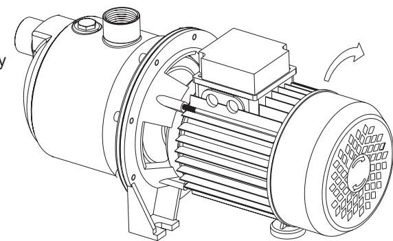
**!** 3. W czasie użytkowania należy zwrócić uwagę na obniżenie poziomu wody i nie dopuścić do wyjścia zaworu dennego lub dolnego końca rury wlotowej ponad powierzchnię wody.
