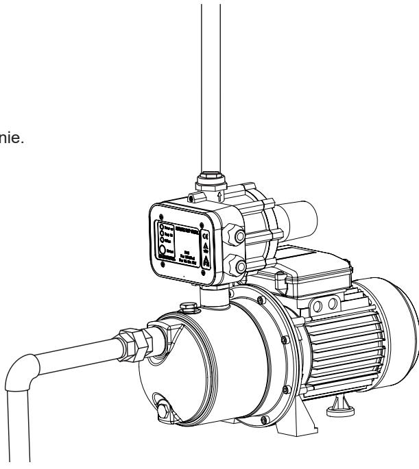
**!** 2. Pompu elektryczną należy zamontować w suchym i dobrze wentylowanym miejscu, w którym można łatwo przeprowadzać naprawy i przeglądy. Aby zamontować pompę elektryczną w ciasnym miejscu, należy postępować zgodnie ze schematem poniżej. Aby poprawić rozpraszanie ciepła, odstęp między ścianą a pokrywą wentylatora powinien wynosić ponad 25 cm.
