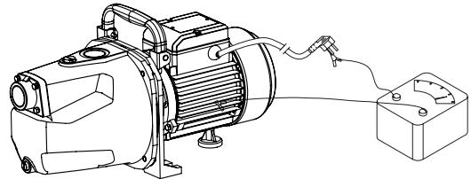
6.2 Vor der Durchführung von Reparatur- oder Instandhaltungsarbeiten die Stromversorgung abtrennen und den Motor gegen versehentliches Wiedereinschalten sichern.
