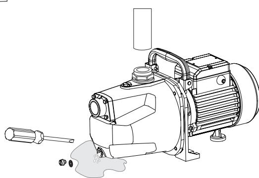
6.5 Jeśli pompa elektryczna nie będzie używana przez długi czas, należy zdementować orurowanie, spuścić wodę nagromadzoną w pompie, przeczyścić główne części i komponenty, zastosować zabezpieczenie antykorozyjne
