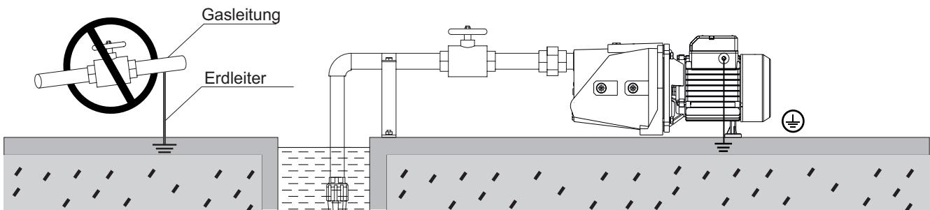
1.2 Bevor die elektrische Pumpe im laufenden Betrieb zum Umsetzen oder zur Fehlerprüfung berührt wird, muss die Stromversorgung unterbrochen werden. In der Nähe des Betriebsstandorts der elektrischen Pumpe sind Waschen, Schwimmen oder Beweiden nicht erlaubt, um Unfälle zu vermeiden.
