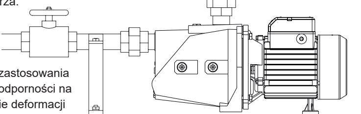
4. Po podłączeniu rury wlotowej do wlotu pompy elektrycznej należy upewnić się, że koniec rury wlotowej, gdzie znajduje się zawór denny i sitko, jest zanurzony w wodzie. Aby zapewnić niezawodną pracę pompy elektrycznej, należy zastosować skuteczny filtr z zaworem dennym, który musi być oddalony od dna wody o ponad 30 cm, aby zapobiec wchłanianiu szlamu lub zanieczyszczeń do komory pompy, co negatywnie wpływa na jej pracę.
