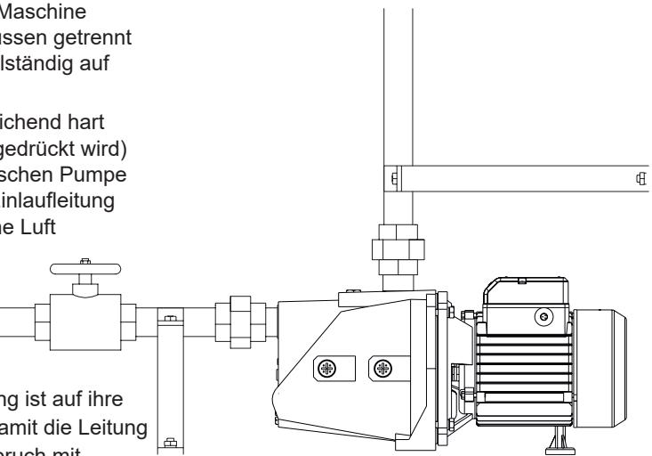
Pumpe führt. Bei Verwendung einer Gummileitung ist auf ihre maximale Temperaturbeständigkeit zu achten, damit die Leitung bei Wärme nicht verformt wird, was zu Leitungsbruch mit Wasseraustritt führen könnte.
