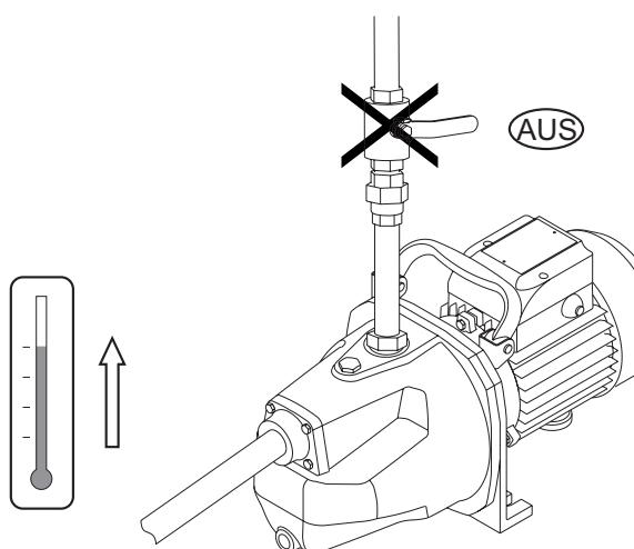
7. Wenn das Ventil am Auslauf geschlossen ist, darf die elektrische Pumpe nicht länger als 5 Minuten betrieben werden. Wenn die elektrische Pumpe ohne Wasserdurchlauf und Wasserwechsel im Pumpenkörper betrieben wird, können die Temperatur und der Druck der Flüssigkeit im Innern ansteigen, Leckagen auftreten oder die Pumpe oder Leitungen beschädigt werden.
