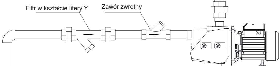
2. Przed użyciem pompy elektrycznej należy wykonać rozruch próbny, którego czas trwania nie powinien przekraczać 10s, ponieważ długotrwały rozruch na sucho spowoduje uszkodzenie uszczelnienia mechanicznego. W przypadku pompy trójfazowej należy sprawdzić, czy kierunek obrotów jest zgodny z oznaczeniem obrotów. Jeżeli kierunek obrotów pompy elektrycznej jest odwrotny, należy natychmiast odciąć zasilanie i zamienić każde dwie fazy pompy trójfazowej.
