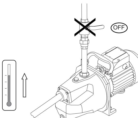
7. Przy zamkniętym zaworze na wylocie pompka nie może być uruchomiona dłużej niż 5 minut. Użytkowanie pompki elektrycznej bez wody przepływającej wewnątrz jej korpusu może doprowadzić do zwiększenia temperatury i ciśnienia cieczy w korpusie, wycieku lub uszkodzenia pompki bądź orurowania.
