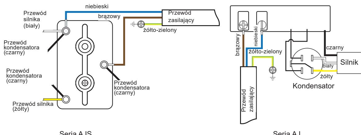
Schemat instalacji elektrycznej trójfazowych pomp elektrycznych przedstawiono poniżej.
